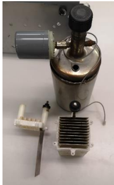
Elektrolysecel (12 plaatjes) uit Reservoir 1 genomen. Bovenop het Reservoir is een drukbeveiliging gemonteerd. Foto: Condit Medicare BV
